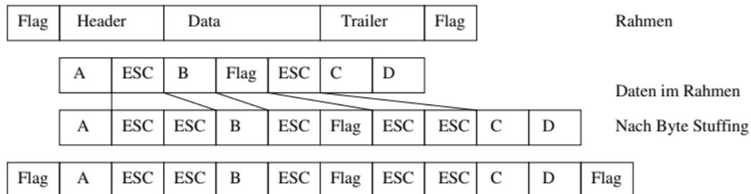
Eventuelle Prüfsummen (z.B. im Trailer) werden vor dem Byte Stuffing berechnet und ebenso behandelt.
