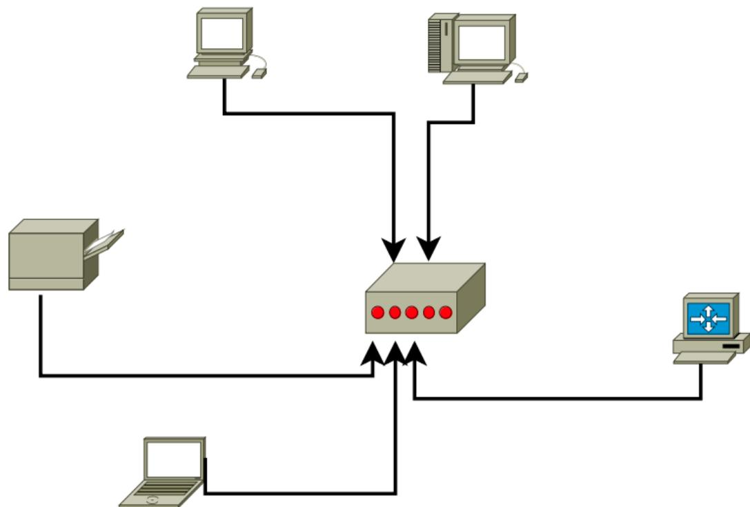
Heutige LANs auf Ethernet-Basis benutzen in der Regel eine Topologie, bei der jeder Endpunkt mit einem Ethernet Switch verbunden ist. Switches sind wiederum mit weiteren Switches oder Routern verbunden.
